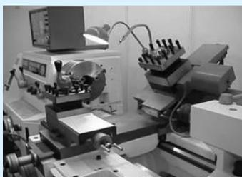
图 1-15 双刀架数控机床
