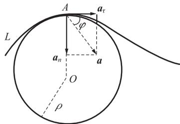
图 1-13 一般曲线运动的加速度
