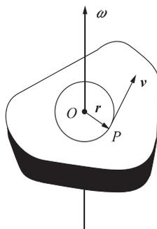
图 1-12 角速度矢量与线速度矢量的关系
