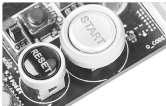
图 2-39 主板上的启动和重启按钮
