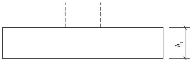
图 2-11 单阶普通独立基础竖向尺寸
