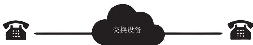
图 2-5 电路交换的示意图
