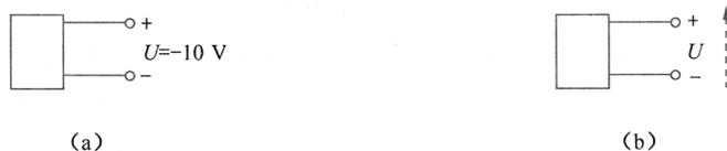
图 1.10 电压的参考方向、实际方向及数值
