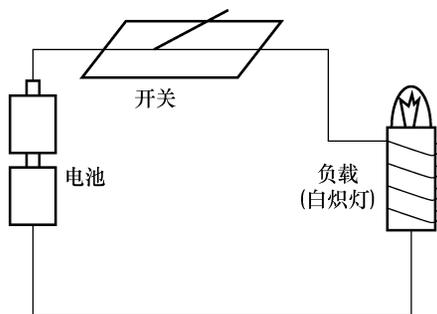
图 1-1 手电筒电路
