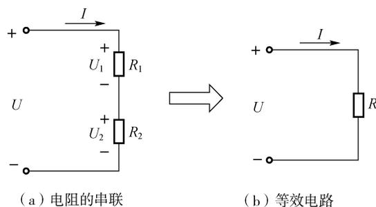
图 2-1 电阻的串联电路
