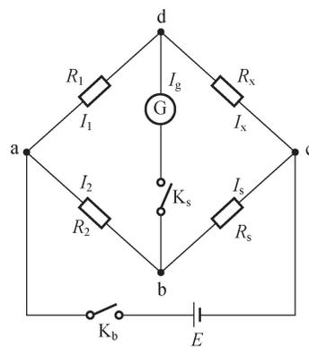
图 1-16 电桥电路
