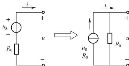
图 2-12 由电压源模型变换为电流源模型
