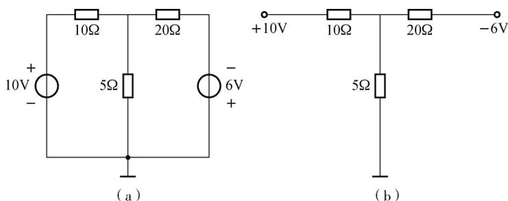
图 1-24 电路图电位表示法
