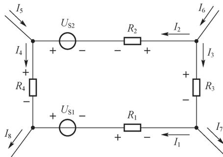
图 1-20 任一电路中的一个回路
