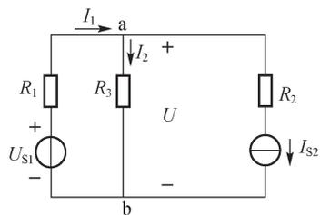
图 2-17 节点电压法
