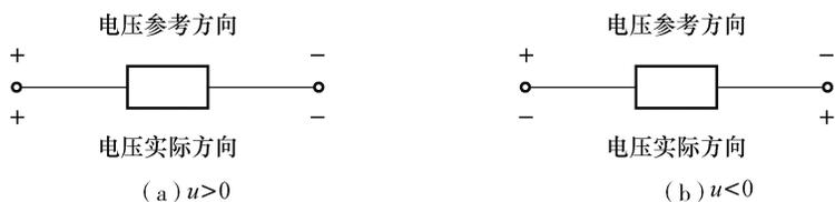
图 1-8 电压的实际方向和参考方向的关系
