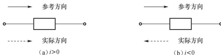
图 1-5 电流参考方向和实际方向的关系
