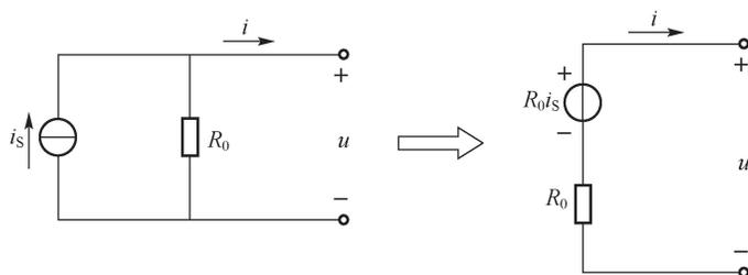
图 2-13 由电流源模型变换为电压源模型
