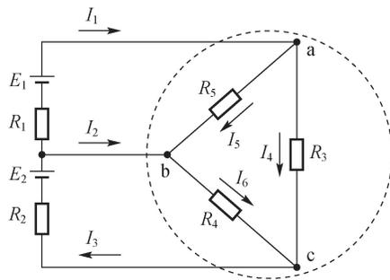
图 1-18 KCL 应用于一个封闭面
