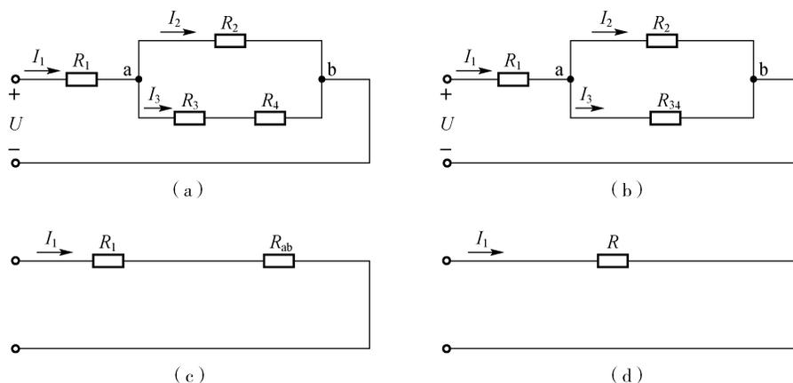
图 2-7 例 2-2 电路图及简化电路
