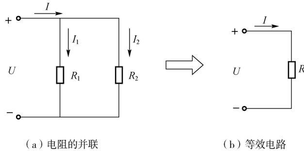
图 2-2 电阻的并联电路
