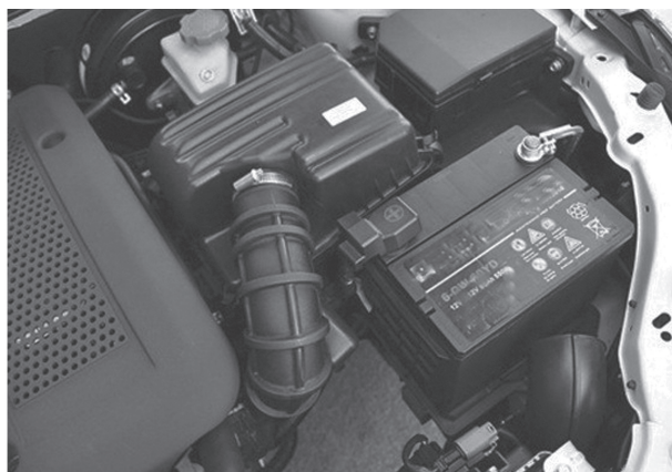
图 2-8 Smart Fortwo MDH 上使用的 AGM 可溶性玻璃纤维铅酸蓄电池
