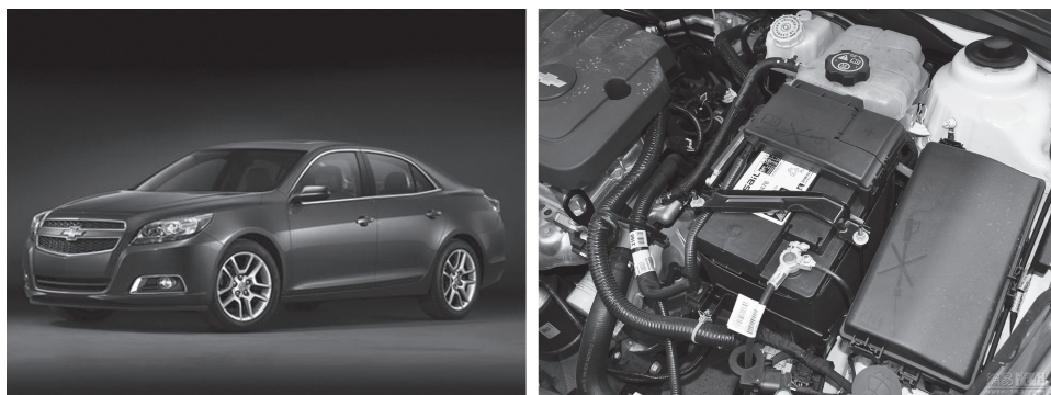
图 2-9 雪佛兰 Chevrolet Malibu 的镍氢蓄电池
