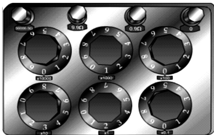
图 2-3 6 旋钮电阻箱读数
