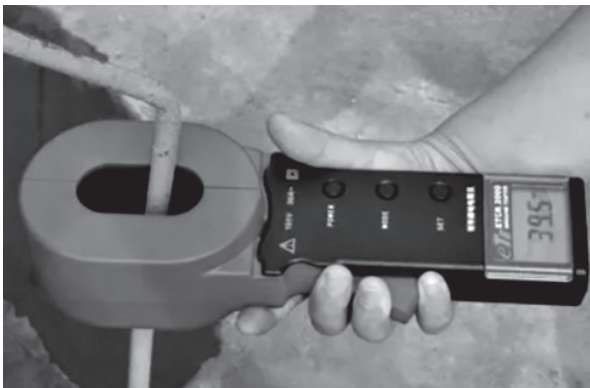
图 1-2-9 钳口闭合测试
