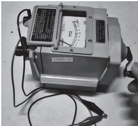
图 1-2-12 兆欧级电阻表短路试验
